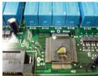
集積回路の破損
